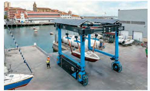
ESPAÑA Náutica. Pórtico automotor marino eléctrico Cliente: PUERTO BERMEO 2022
